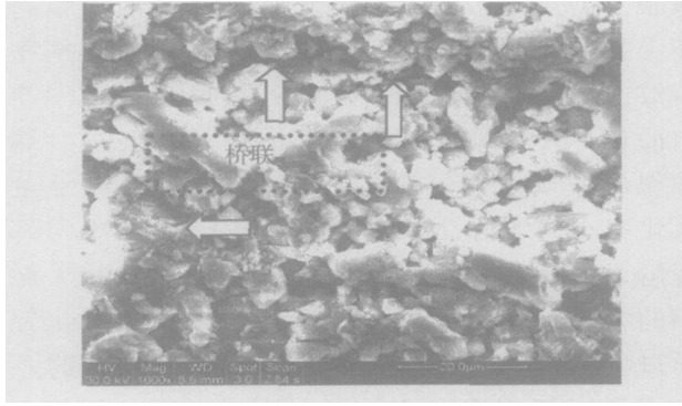
图 6 1600 °C 铝质量分数为 16% 的支撑体 SEM 照片
